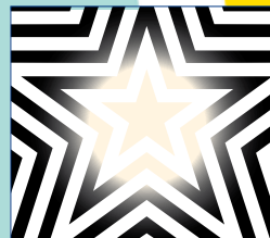
Feuille test après stérilisation Résultat non conforme
